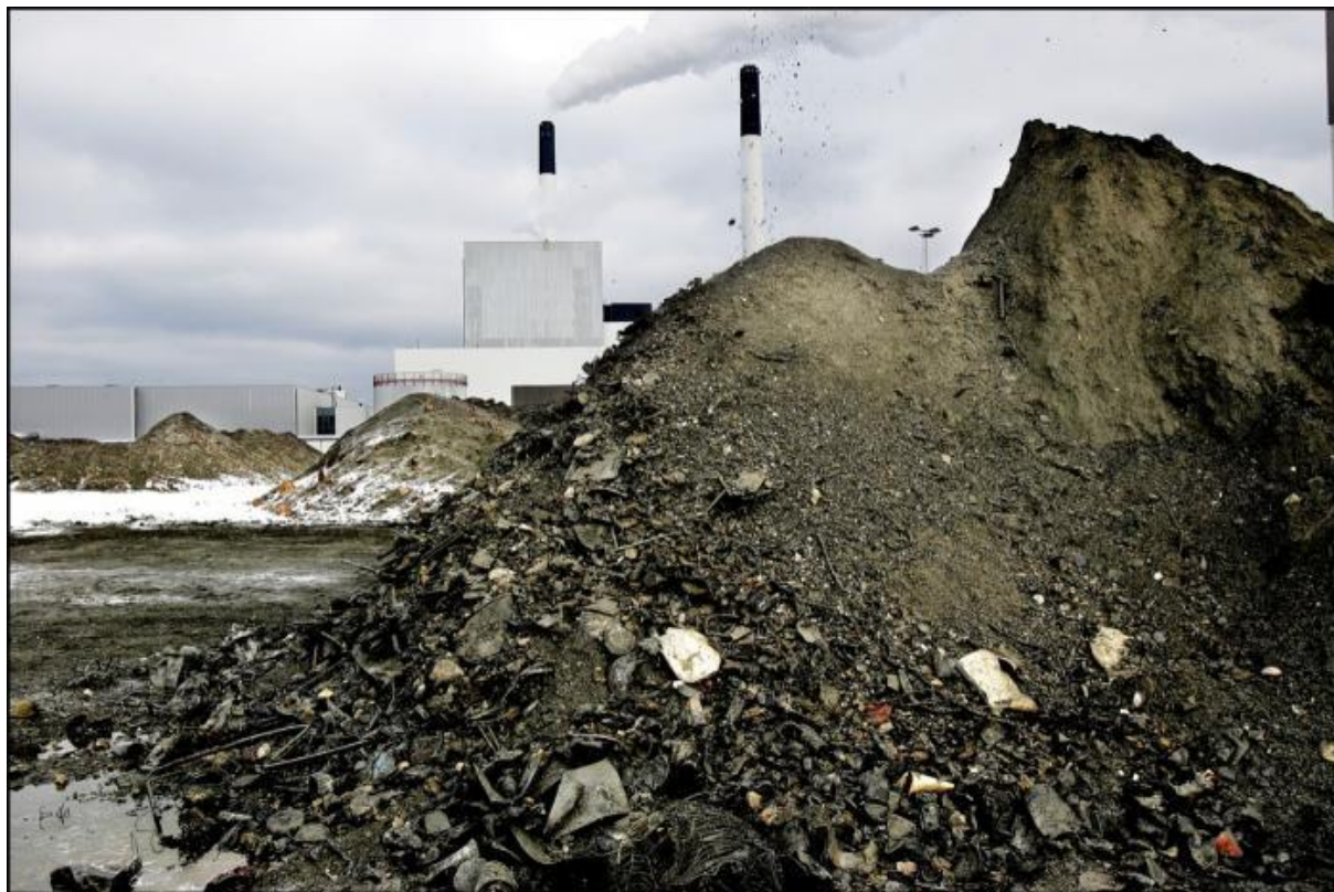
Obr. 3: Popel a struska ze spálených komunálních odpadů v kodaňské spalovně. Foto: Erik Refner ( www.information.dk ).
