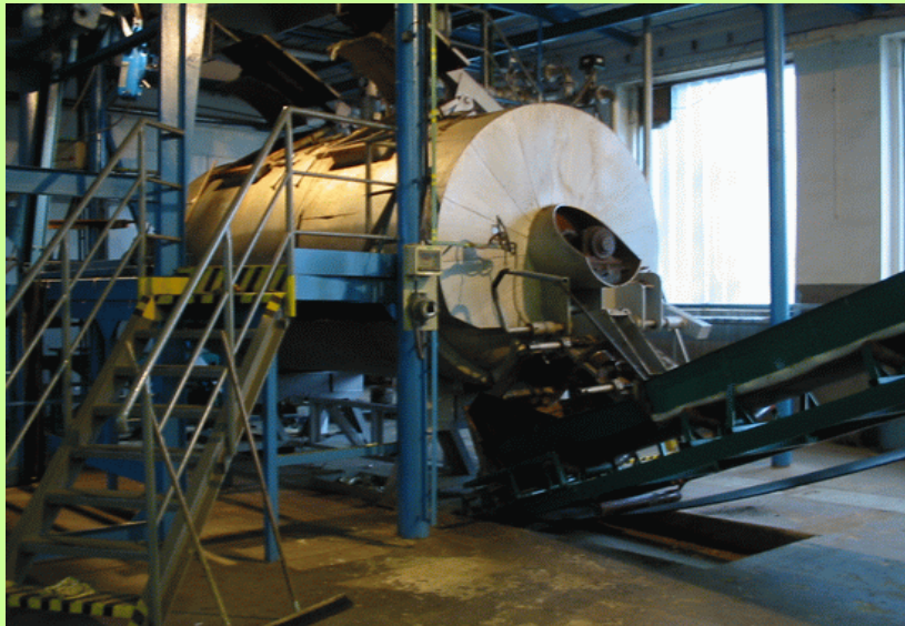
Autokláv ve společnosti Wastech, a.s. v Dubenci, jedním z mála případů, kdy se zdravotnický odpad po dekontaminaci ukládá na skládku
