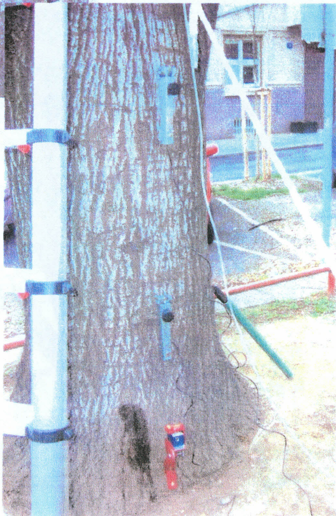
Obrázek 4-5 : Pohled na umístění přístrojů při realizované tahové zkoušce.
