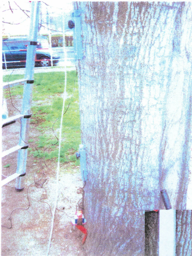
Obrázek 4-5 : Pohled na umístění přístrojů při realizované tahové zkoušce.
