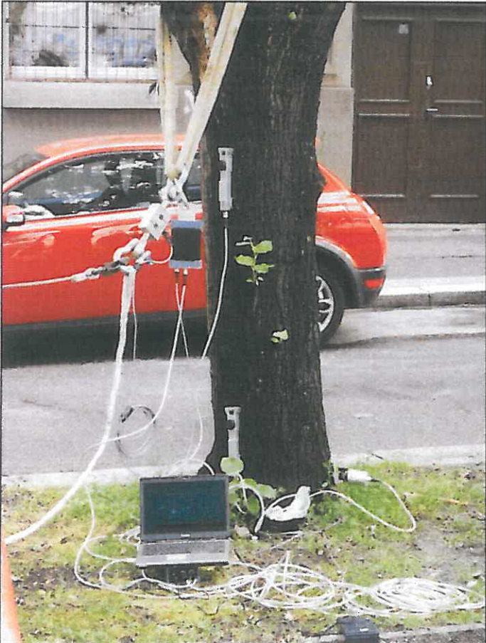
Obrázek 6-7: Pozice přístrojů při tahové zkoušce (1. a 2. směr tahu)
