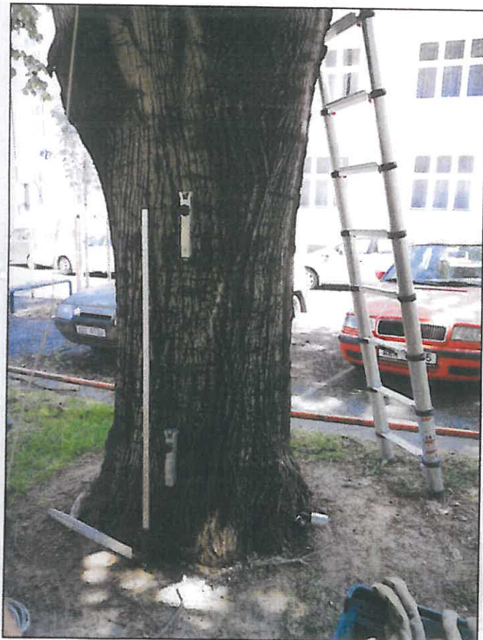
Obrázek 22-23: Pozice přístrojů při tahové zkoušce (1. a 2. směr tahu)
