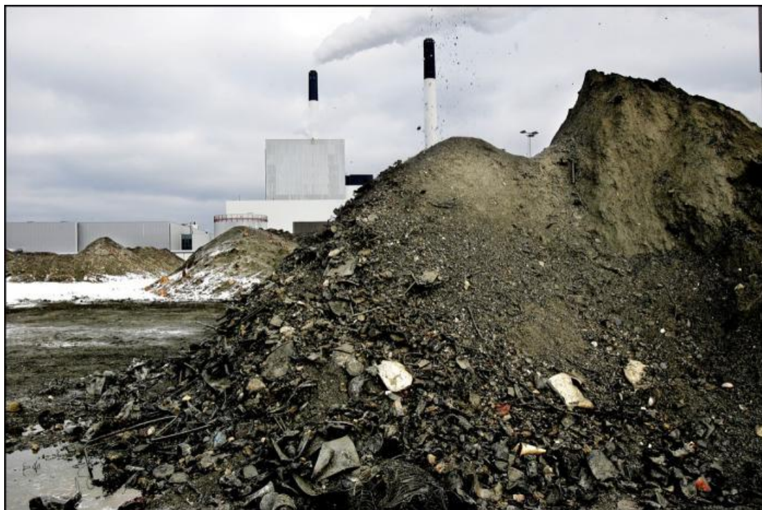
Obr. 2: Popel a struska ze spálených komunálních odpadů v kodaňské spalovně. Foto: Erik Refner ( www.information.dk ).
