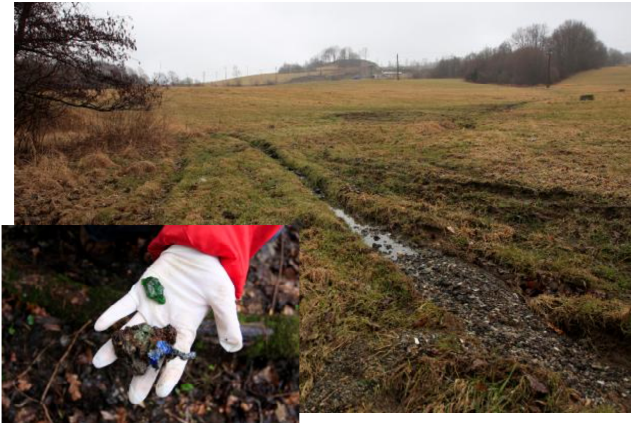
Obrázek 2: Tato lokalita je blízko česko-polských hranic. Směs popílku a popela ze spalovny komunálního odpadu zde byla použita pro vytvoření překryvné vrstvy na skládce (na vrcholu kopce na této fotografii) a rovněž jako výplň odvodňovacího příkopu, který vede dolů z kopce přes pastvinu pro dobytek a končí v blízkém potoce. Koncentrace PCDD/F naměřené v tomto materiálu činily až 0,05 ng TEQ na gram sušiny. Foto: Jan Losenický, Arnika, listopad 2011.
