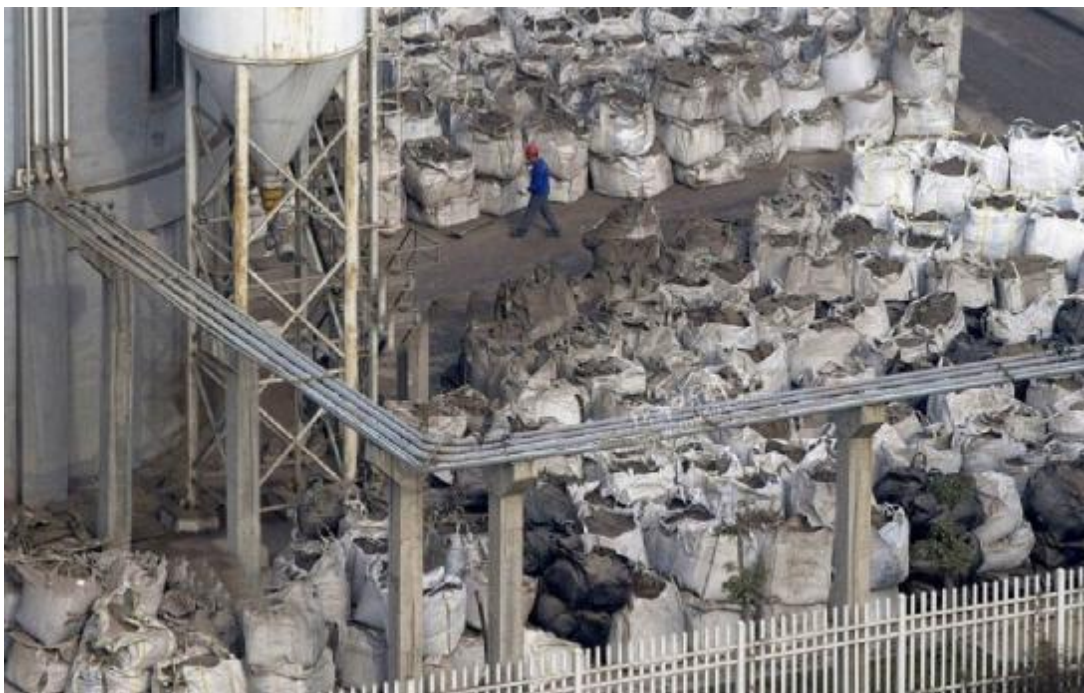
Obrázek 8: Popílek v pytlích typu big bag skladovaný v podmínkách, v nichž je vystaven povětrnostním vlivům ve spalovně TKO v městě Hanyang, Wuhan, Čína. Zdroj: (Zhang, Huang et al. 2015).
