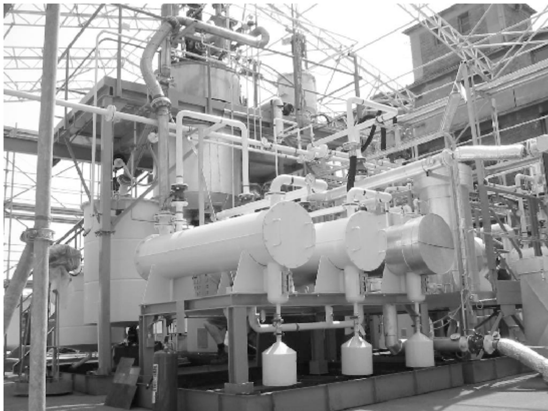
Obrázek 31: Jako druhý stupeň zpracování kontaminovaných zemín ve Spolaně Neratovce rozkládala POPs jednotka BCD. Zdroj: Kubal, Fairweather et al. (2004).
