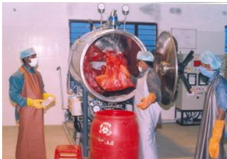
Obrázek 32: Příklad parního autoklávu pro zdravotnický odpad. Zdroj: G.J.Multiclave ( India ) Pvt. Ltd.
