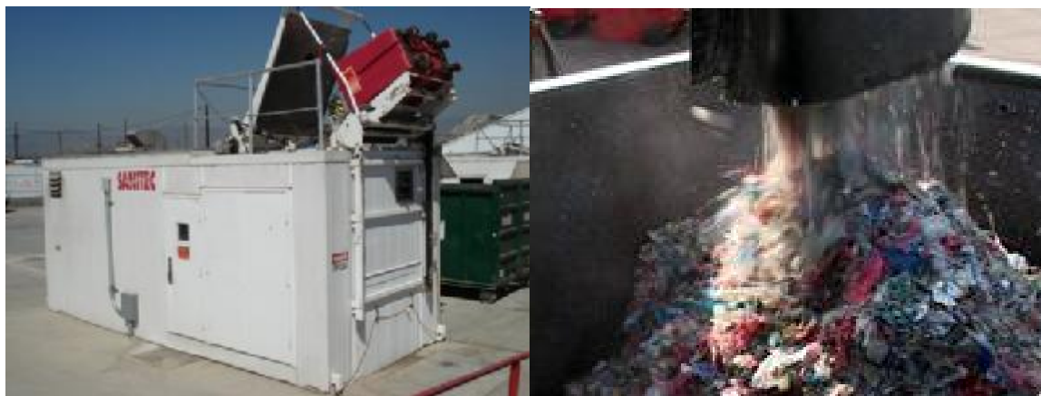
Obrázek 33: Dezinfekční jednotka firmy Sanitech, využívající mikrovlnné záření. Zdroj: Sanitech Industries, Inc.
