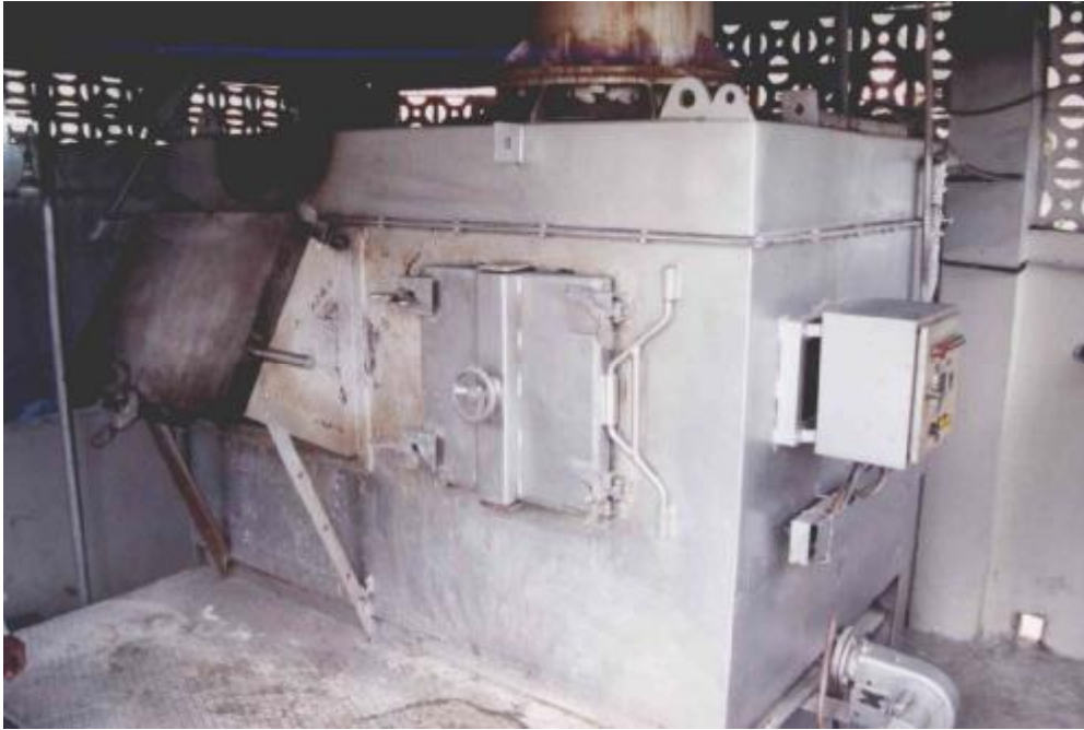
Obrázek 39: Pec se dvěma komorami v jedné z malých spaloven zdravotnického odpadu v Pákistánu. Foto: Jindřich Petrlík, Arnika, březen 2005.
