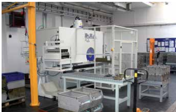
OBRÁZEK Č. 11: Nové odmašťovací zařízení Midi 400 v provozu Brisk Tábor. Díky jeho instalaci mohl výrobce zapalovacích svíček nahradit ve výrobě do té doby používaný tetrachlorethylen. Foto: Brisk Tábor, a.s.
